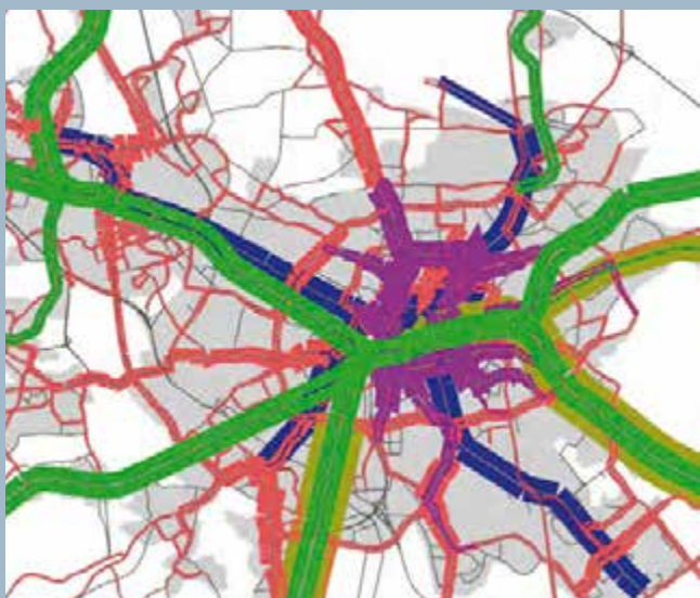
DIVAN simuliert die Belastung von Strecken.
